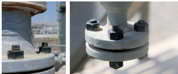
フィールドテスト後のナノテクト®表面処理金属部品 (ボルト・ナット)
