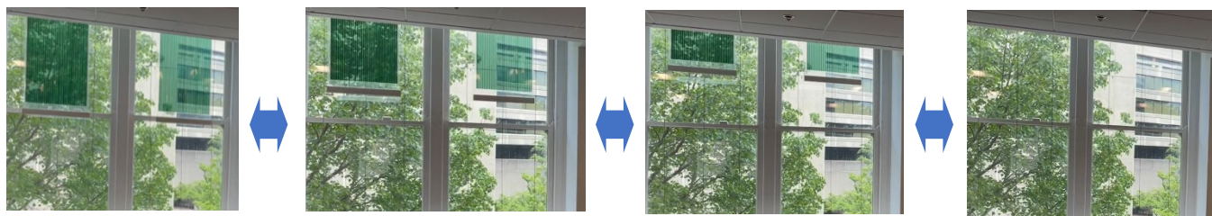
Figure 3. 実際に実装された OPV ロールカーテンの駆動の様子
