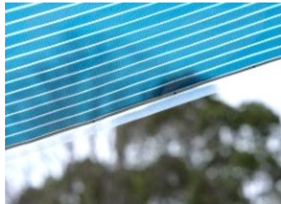
Fig 2.光透過性のある ST-OPV
