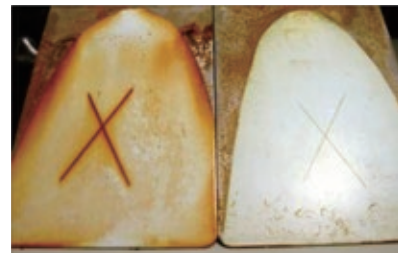
水系DTMでの防錆比較試験 10日間の水中浸漬試験
